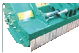
Gleitkufen, verzinkte Blechlamellen
